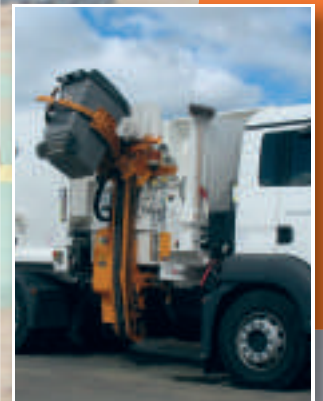
P2 La collecte automatisée des déchets
